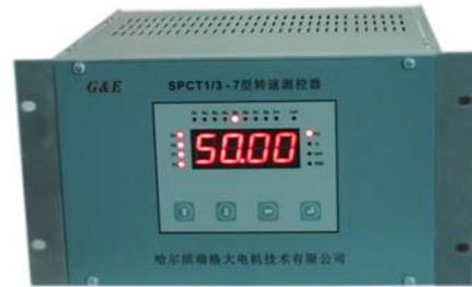
SPCT1/3-7 转速测控器采用三通道信号并行冗余测量方式，设有硬件看门狗、具有软件差分抗干扰、4-20mA 模拟量输出、电源断电报警以及传感器故障报警功能。
